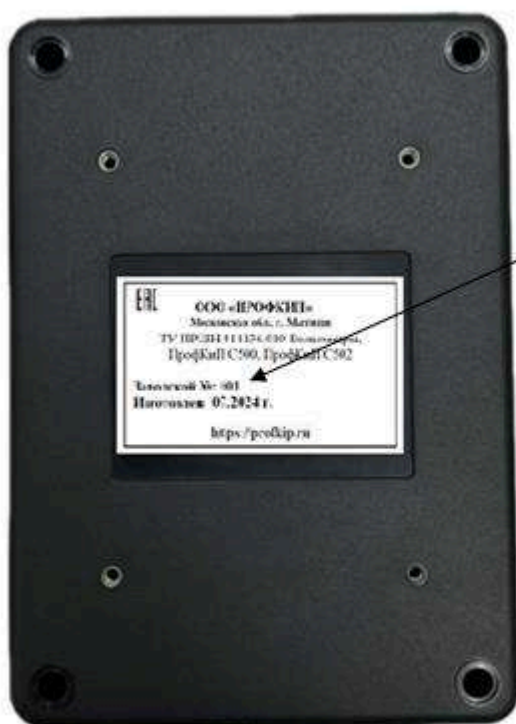
Рисунок 2 – Место нанесения заводского номера
