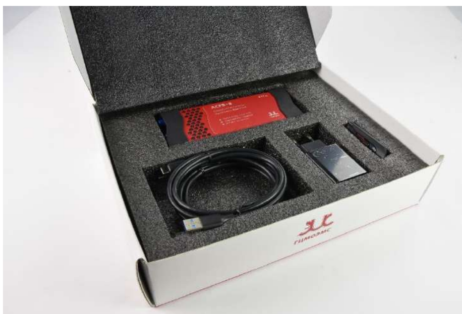
Рисунок 6 – Комплектность средства измерений (анализатор спектра реального времени АСРВ, кабель питания, кабель управления и передачи данных, блок питания, флеш-накопитель)
