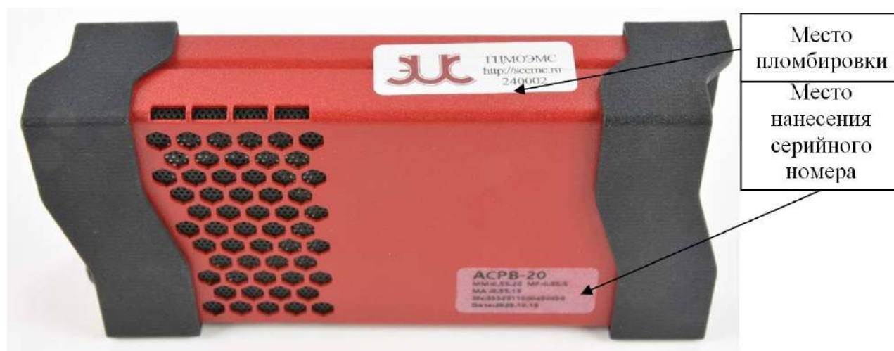
Рисунок 5 – Схема пломбировки от несанкционированного доступа и место нанесения серийного номера, идентифицирующего каждый экземпляр средства измерений
