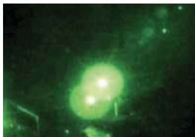
Усиление изображения: изображение перенасыщено из-за направленного на камеру источника света.
